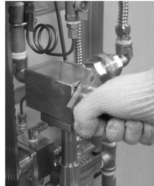
カバーフランジを左右に回しながら徐々に手前に引上げて取外してください。カバーには内部部品がユニットとして接続されています。
