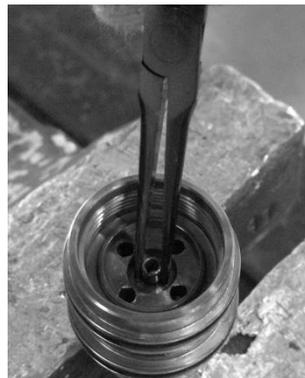
次に、カバーにホルダー(内部部品付)を手締め状態で取付け、バルブシートを規定トルクで締めます。その後の取付方法は、前述の(4)と同じです。
