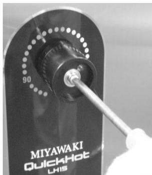
外装パネル上下面部のビス(A)M4 各 2本をプラスドライバーで緩めて取外してください。外装パネルを手前に引き、パネル盤面上の圧力計と温度計の表面に傷が付かないようにゆっくりと取外してください。
